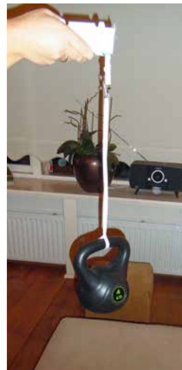
Met een flinke stalen kogel werd getest of het stekertje stevig genoeg zat.
